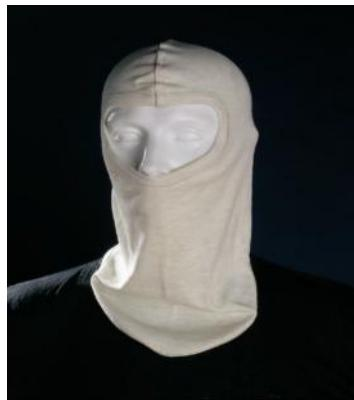
İtfaiyeci başlığı ham keten renginde olup 93% meta-aramid, 5% para-aramid, 2% antistatic fiber, 285 gr/m<sup>2</sup> örgü kumaştan üretilmiştir. EN 13911:2004 standartına uygun ve CE sertifikalıdır.
