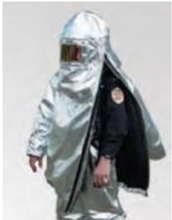
EN 1486 standartlarına uygun CE sertifikalı alüminize ısı ve aleve yaklaşma elbiseleri profesyonel itfaiyeciler içindir. Dış katman; 100% aramid alüminyum kaplı, REX 370 gr/m<sup>2</sup>, fitilli örgü, ısı bariyeri: keçe 50% aramid + 50% Lenzing FR, 520 gr/ m<sup>2</sup>, iç astar: 50% aramid + 50% Lenzing FR, 100 gr/ m<sup>2</sup> olmak üzere üç katlıdır.
