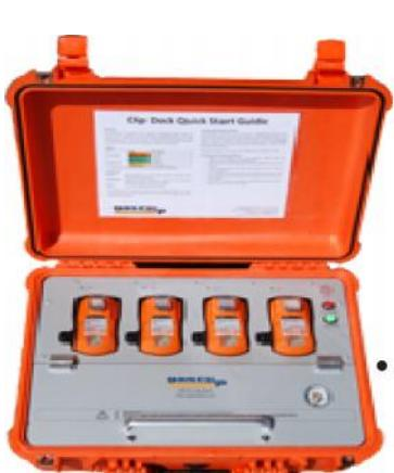
Düzenin bir şekilde test yapar ve test süresini ve gaz kullanımını azaltırken tüm gözlenen verileri kaydedeler. Aynı anda 4 detektörü test edebilir. Zaman ve ekonomi anlamında tasarruf sağlar.
