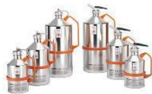
Yüksek kalite paslanmaz çelikten mamul güvenli kapları(0,6 mm kalınlık) PTFE conta ile yüksek kimyasal direnç sağlar. Yanıcı sıvıların güvenli dolum ve ölçümünde, aluminyum boyalı kulp ile kolay taşıma, alev tutucu ağızlık ile açık aleve dirençli, kendinden kapanan ölçüm aparatı içinde basınç kontrol valfi, parlak veya mat yüzeyli ve taşıma amaçlı kullanılan güvenli kaplardır.
