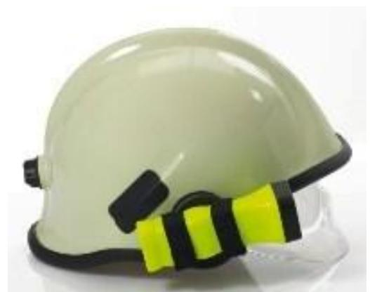
Four LED EX ,Darbelere dayanıklı şarz edilebilir pilli kafa ve el feneridir. 4 x 5mm LED ampülleri ile çok açık beyaz bir ışığı 12 saat kadar vermektedir. NiMH pilleri sayesinde 1000 defaya kadar şarz edilebilir. İtfaiyeci müğferlerine de takılır. IP65 koruma sınıfındadır. 150 gr ağırlığındadır. II 2 G Ex ib IIC T4 / II 2 D Ex ibD 21 T 135°C(T4).
