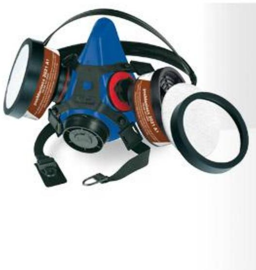
Kit A1 filtre ile organik gaz ve buharlara( boyalar, cilalar, reçineler ve çözücüler) ve P1滤器 ile katı ve sıvı aerosollere karşı koruma sağlar. Bunlar cilalama, boyama ve laminasyon ve mekanik parlatma işleri sırasında oluşan tipik maddelerdir. P1滤器 A1滤器in kullanım ömrünü uzatır.
