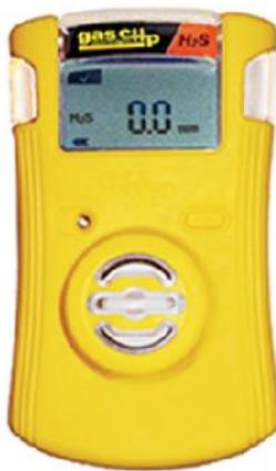
Ebatı 85x50x28mm, ağırlığı 76 gr., sıcaklık aralıkları, H2S -40 +50 °C, CO -40 +50 °C, O2 -35 +50 °C, yoğunlaşmaz bağıl nem %5-95% aralığında, görsel, titreşim ve sesli alarm min. 95dB, aktive olduktan ve her 20 saatten sonra kendi kendini test eder, sürekli otomatik pil ve sensör testleri, IP 67/ EMC directives 89/336/EEC, UL 913 ve CSA-22.2 No 157 Class 1 Division 1&2 Groups A, B, C and D; ATEX: II 1 G Ex ia IIC T4; IECEX: Ex ia IIC T4, aktive olduktan sonra 2 sene garantiili, ölçüm aralığı
