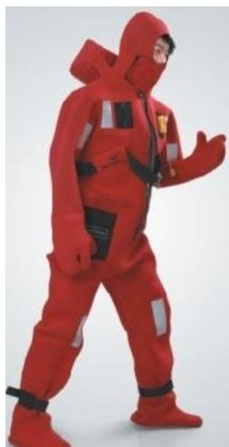
Dalış elbisesi, düdük, can yeleği geri yansıtıcı reflektif bant ile birlikte. Malzemesi neopren, batmama 150N, kalınlık 0,5 cm, 0-2 °C arasında 6 saat kalınabilir, MED, SOLAS onaylıdır.
