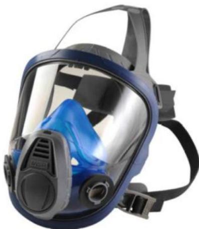
Bayonet bağlantılı MSA 3200 tam yüz maskesi toz, duman, sis, buhar ve gazlar için koruyucu filtreleri ile birlikte kullanılır. Geniş transparan polimer camı ile birlikte rahat kullanım sağlar. CE EN 136 sertifikalıdır. Karbon monokside karşı koruma sağlamaz ve ayrıca havadaki oksijen değerinin %17den az olduğu yerlerde kullanılılmaması önerilir.
