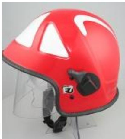
Kevlar ile güçlendirilmiş cam elyaf kompozit dış kabuk, parlak boyalı UV dirençli, PU darbe astarı, çıkarılabilir deri baş bandı, ense askısı ayarlanabilir, 3 noktadan alev geciktirici Nomex çene bandı çabuk çıkarılabilir tokası ile, dahili çekilebilir göz koruyucu, alev geciktirici dahili yüz kalkanı ışığı iletir ve darbe koruyucu özellikle, çift katlı alev geciktirici Nomex boyun koruyucu ile birlikte. EN443:2008, Tip A & B. ve EN14458:2004 standartlarına uygun CE sertifikali.
