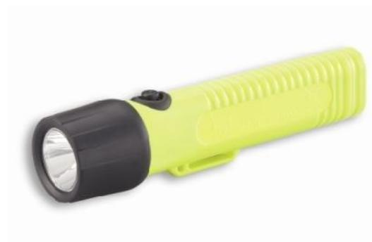
HL 10 EX LED pilli el feneri, aynı zamanda itfaiyecilerin baretlerine de uygundur. Darbeye dayanıklı ve su geçirmez plastik gövdeden IP67. 167 gr. ağırlığında ve 11 saat 4xAA kalem pil ile ışık verir. 1 m'ye kadar su altında kalabilir. 150 m'ye kadar ışık verir. II 2 G Ex ib IIC T4 / II 2 D Ex ibD 21 T 135°C(T4).
