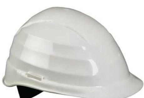
ABS elektrikçi breti, 21cm lik içte deri döşeme ile konfor sağlar, kulaklı takmaya uygun, EN 397 440V, EN50365 1000V ve ANSI Z89.1 20000V dayanıklıdır. CE belgeliidir.
