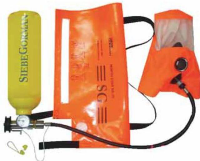
ELSA hava silindiri, T vana, manometre, basınç düşürücü vana, hava hortumu ve başlığından oluşan acil durumlarda kaçışta yardımcı bir solunum setidir. Başlık hafif geniş vizörlüdür ve Proban kumaştan imal edilmiştir. Omuz çantası açıldıktan sonra hemen başlık takılarak hava sağlanır. Çelik silindirler 2 lt. 200 bar veya 3lt. 200 bar olarak veya kompozit tüp seçenekleri mevcuttur. Deniz ve askeri amaçlı kullanılır.
